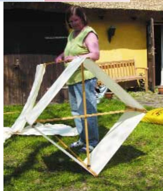
Längsstab trifft. Die Stopper verhindern so das Verrutschen des jeweiligen Spreizstabes. Insgesamt 22 normale Stopper müssen gewickelt werden.
